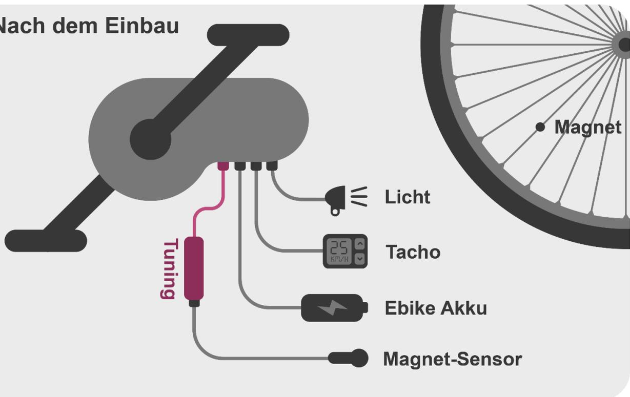
**\* Bei manchen Fahrrädern ist der Magnet nicht an einer Speiche, sondern z.B. an der Bremsscheibe befestigt.**
